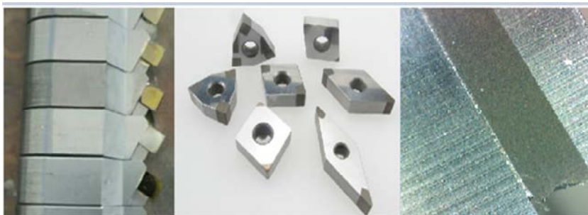
图2 小尺寸刀具真空焊接实例与焊缝
