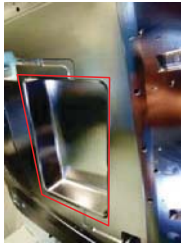
红线内区域为JH刀具加工后表面，以外区域为金鹭加工表面
